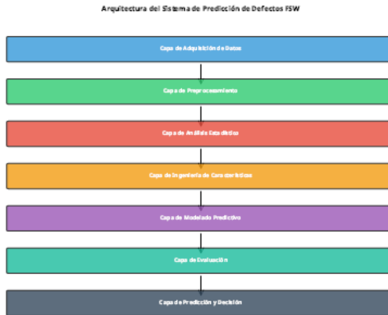
Fig. 3: Arquitectura conceptual del sistema de predicción de defectos, ilustrando el flujo desde la adquisición de señales hasta la decisión de clasificación
